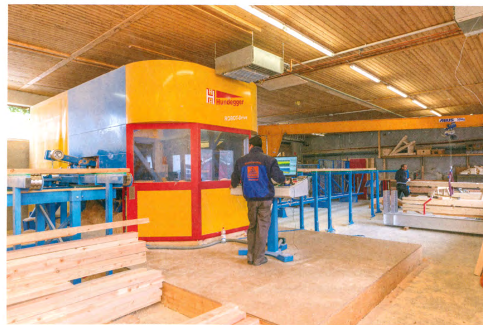
Letztendlich fiel Hummels Wahl auf die Robot-Drive Solo von Hundegger. Als kostengünstige Variante der Robot-Drive wird sie ohne separates Sägeaggregat ausgeliefert, bietet aber mit einem 6-Achs-Aggregat den geringen Platzbedarf und die hohe Flexibilität des teureren Schwestermodells.
